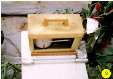
недельные термографы с предохранением их от солнечного нагревания при помощи защитных экранов из алюминиевой фольги. Для контроля использовались максимальные и минимальные термометры, укладываемые на подставке в теплице рядом с термографом ( рис. 2). Эти термометры защищались от солнечного нагревания с помощью общего экрана из алюминиевой
